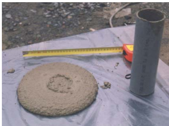
Kuva 12. Notkeuden mittausta työmaalla käy helposti 250 mm pitkän ja 75 mm paksun muovisen viemäriputken avulla.
